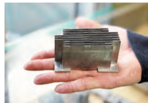
▲アルミの放熱板を重ねたヒートシンク
