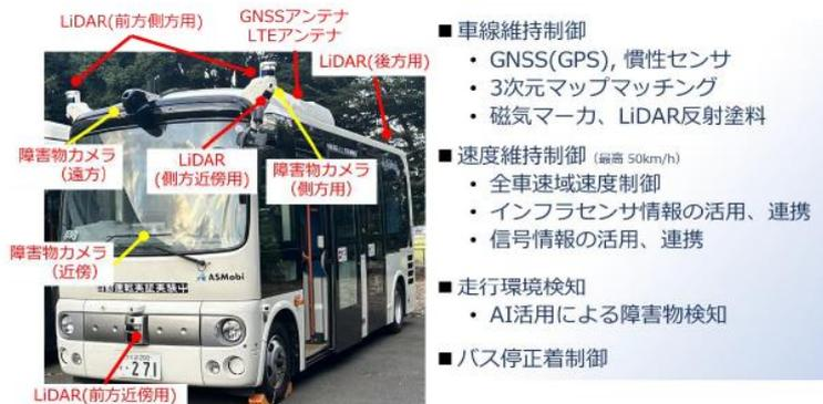
図 1 導入車両の概要
