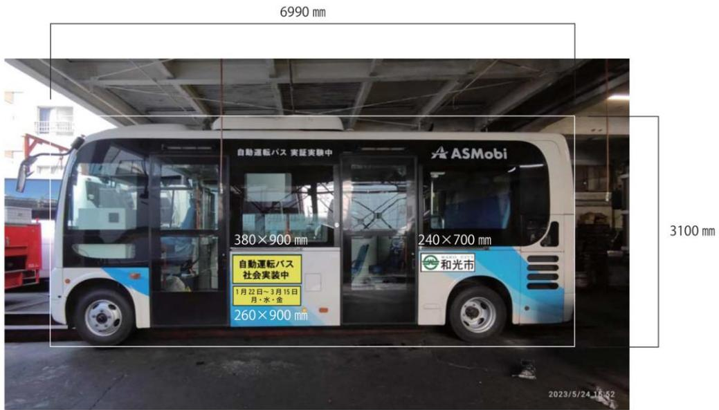
図 3-11 マグネットシート配置箇所（車体左側面）
