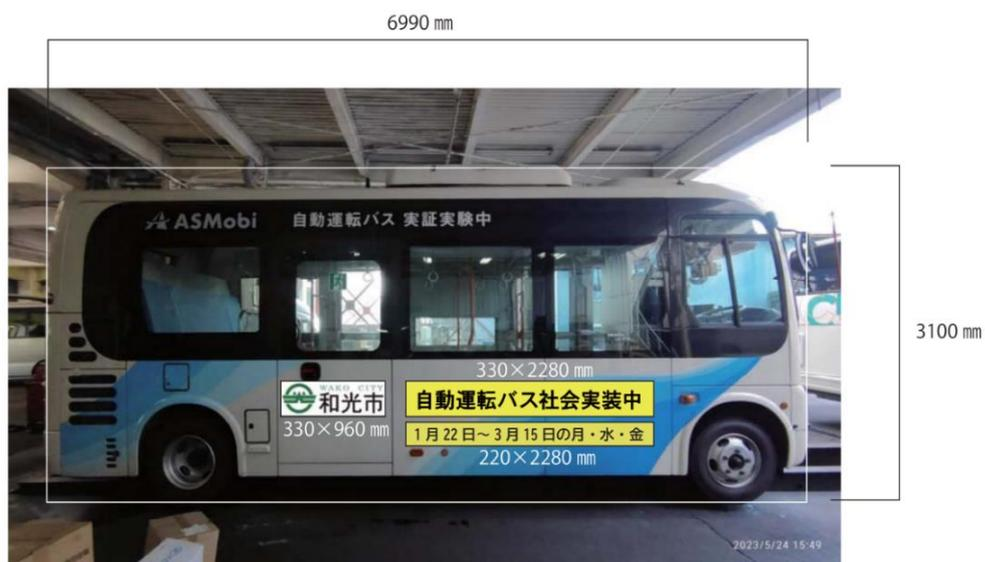
図 3-10 マグネットシート配置箇所（車体右側面）
