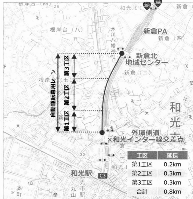
図 2-25 1 期区間の概要及び設定工区
