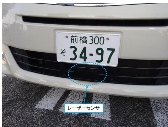
図-4 レーザーセンサ（正面拡大図）
