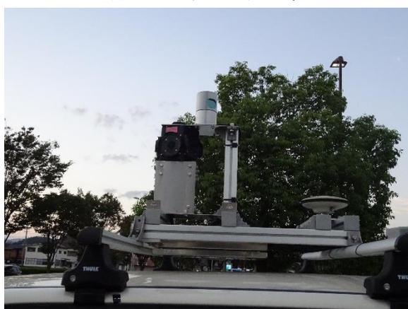
図-3 レーザーセンサ・全方位カメラ・GNSS
