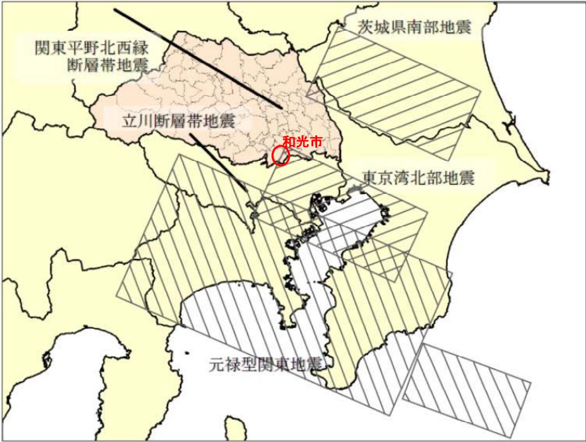
図2.1 平成25年度埼玉県被害想定<sup>[3]</sup>における想定地震の断層位置
