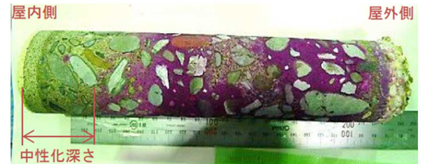
コンクリートの中性化深さ
