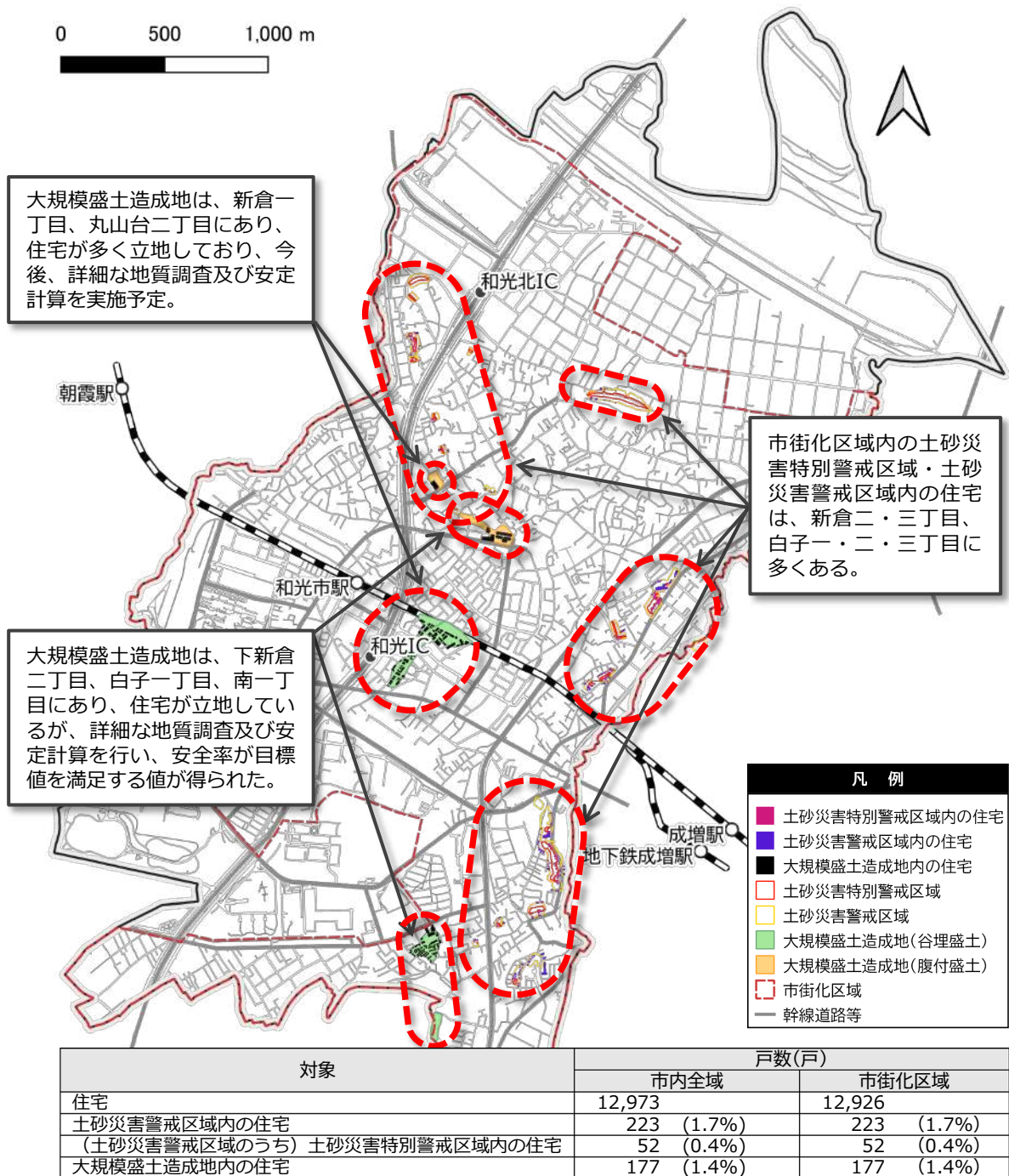
図 6-15 土砂災害(特別)警戒区域・大規模盛土造成地と建物分布の重ね図
