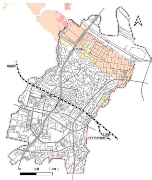
図 2-35 新河岸川流域の計画規模降雨での洪水浸水想定区域等
